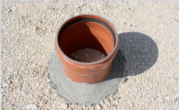
Bild 4: Aufbau Schnelltest „Wasserdurchlässigkeit“
