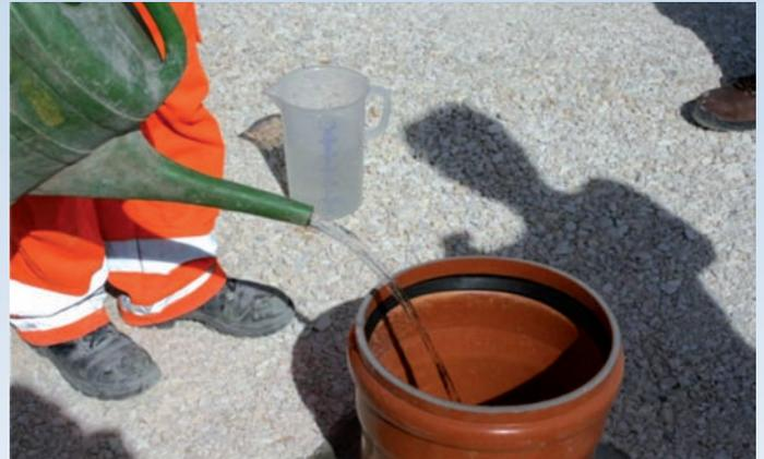
Bild 5: Versuchsdurchführung Schnelltest „Wasserdurchlässigkeit“
